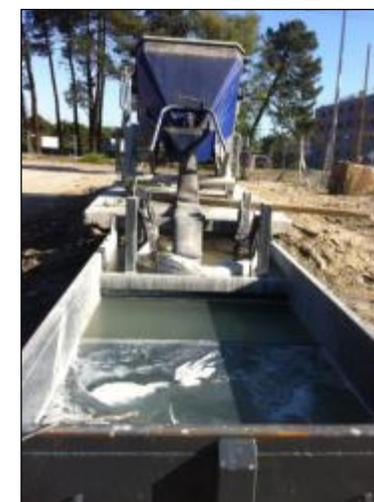
*Benne de décantation pour le béton*
